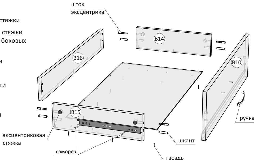
Порядок сборки соединений на эксцентриковые стяжки
